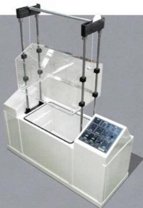
Diese modifizierte Ausführung einer 400 Liter Salznebeltruhe ist mit einem transparenten Deckel ausgestattet. Mit einer mechanischen Hebevorrichtung lässt sich der Deckel senkrecht nach oben schieben. Dies ermöglicht ein Beschicken des Prüfraums von zwei Seiten und eine Rundumkontrolle der Probanden. Zusätzlich wird das Kammervolumen auf 600 Liter vergrößert.
