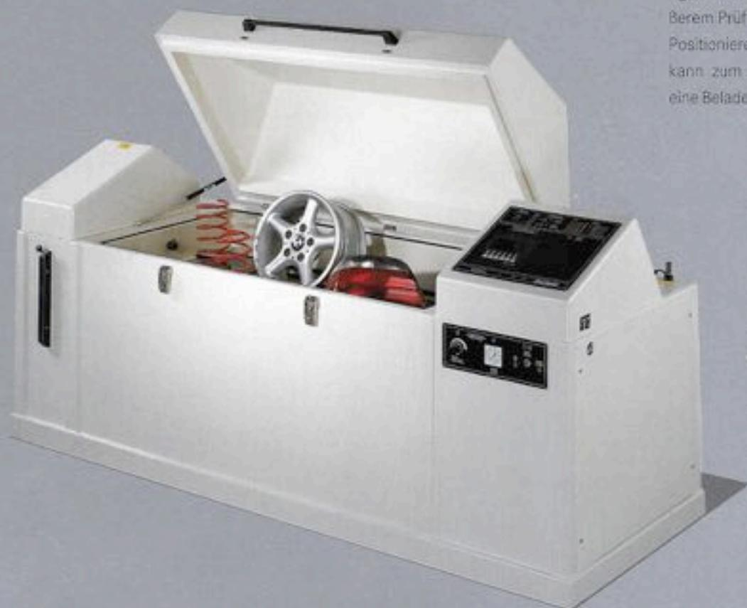
Die Truhe wird von oben bestückt. Die niedrige Beladekante gestattet auch bei größerem Prüfraumvolumen ein problemloses Positionieren der Proben. Darüber hinaus kann zum Einlegen schwerer Einzelteile eine Beladevorrichtung verwendet werden.
