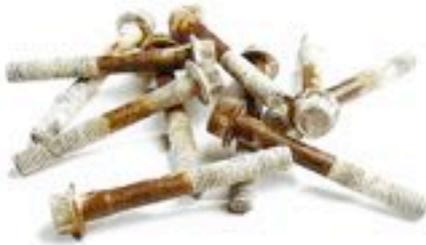
*Schrauben nach einem Testzyklus im Schadgas-Klima des Liebherr Constamatic® G*
