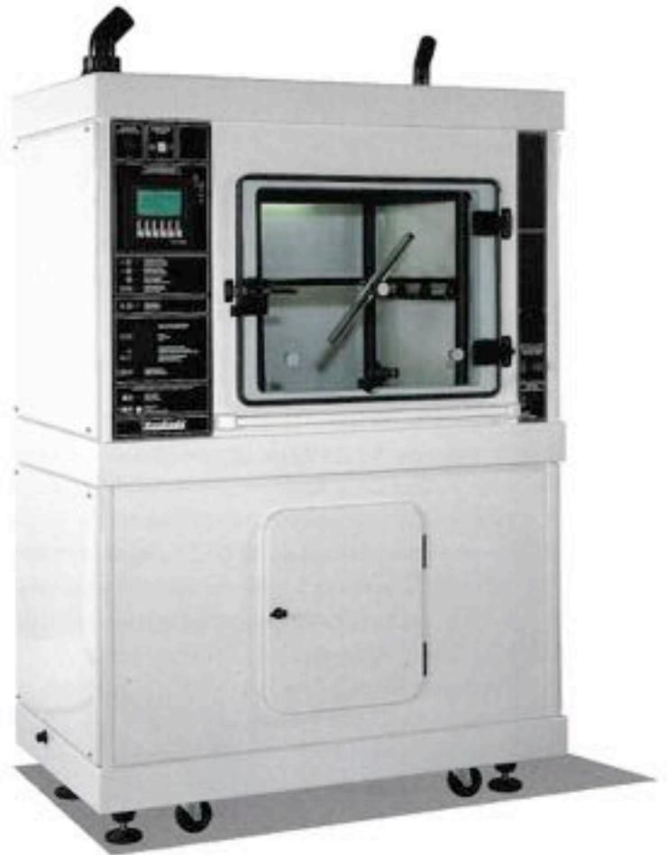
Das Gerät verfügt im Prüfraum über drei unabhängig voneinander programmierbare Antriebswellen, die mit den Probeaufnahmesystemen bestückt sind. Die Probanden werden zyklisch in die Testlösungsbehälter eingetaucht bzw. dem Kondenswasser-Klima ausgesetzt.
