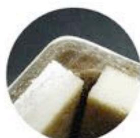
Hochwertige Glasfasermatten in Kombination mit mittelreaktiven Polyesterharzen bilden die einzelnen Schichten des Liebisch-Gehäuses. Durch das Hand-Laminierverfahren wird eine einwandfreie Haftung zwischen Faser und Polymer gewährleistet.
